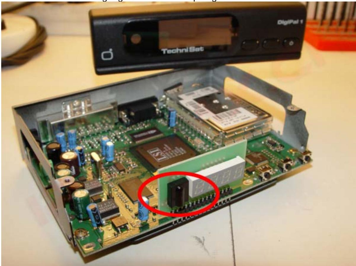
Diesen gilt es also auszulöten und an 3x 6 Meter langen Kabeln zu verlängern. Der IR-Empfänger wird im beifahrerseitlichen Fussraum installiert. Da ist recht einfach hinzukommen.
