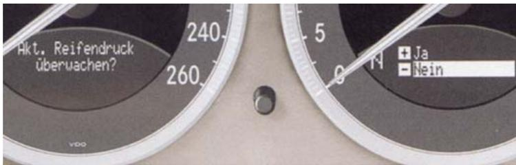
Mit der Taste **+** (Ja) aktivieren Sie die Reifendruckkontrolle (7).
