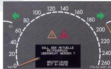
Taste <sup>®</sup> drücken, um die Reifendruckkontrolle zu aktivieren.
