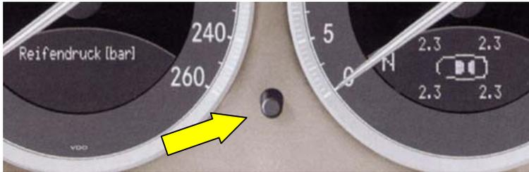
Reifendruck wird angezeigt.
