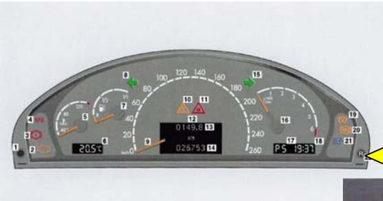
Taste <sup>®</sup> rechts unten am Kombiinstrument gedrückt halten, bis die Anzeige **„SOLL DER AKTUELLE REIFENDRUCK ÜBERWACHT WERDEN?“** erscheint.
