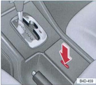
Die Tasten für die Menüsteuerung befinden sich im Ablagefach auf der Mittelkonsole hinter der Schaltkulisse.
